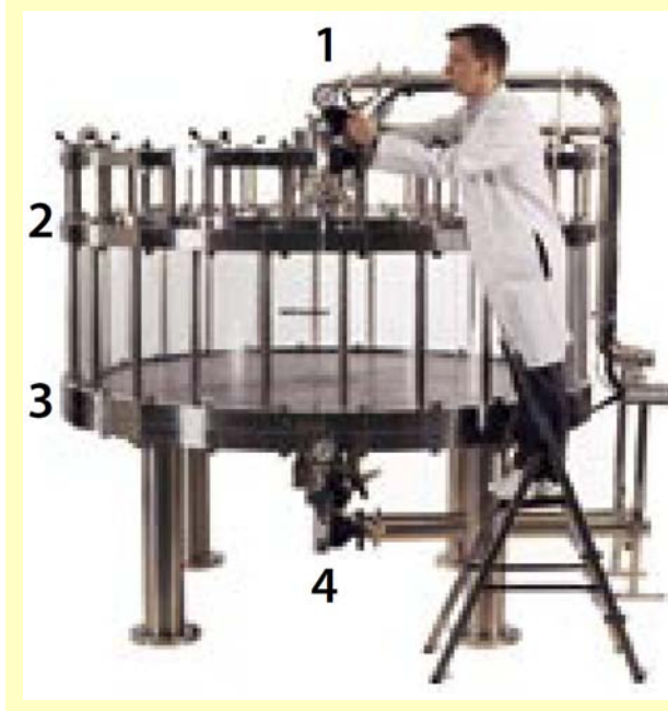
図 1: TOC を用いた洗浄評価のためのカラムのサンプリング; 1(入口弁)、2(カラムガスケット)、3(ベースガスケット)、4(出口弁)、(WWW.GEHEALTHCARE.COM)
